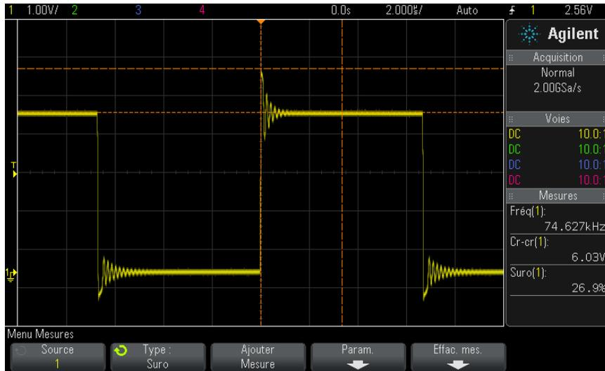
**Figure 34** Mesure automatique de la suroscillation
