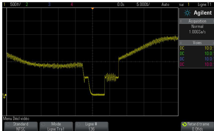
**Figure 15** Exemple : déclenchement sur la ligne 136
